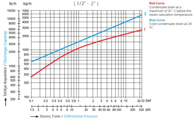
ΔP = Giriş Basıncı / Inlet Pressure - Çıkış Basıncı / Outlet Pressure
